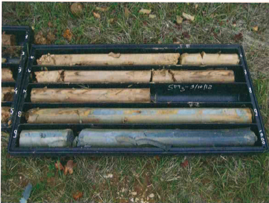
Foto nº 10 – Stratigrafia da “– 5 m/pc a – 10 m/pc”
