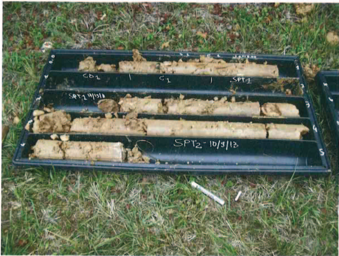
Foto nº 9 – Stratigrafia da “pc a – 5 m/pc”
