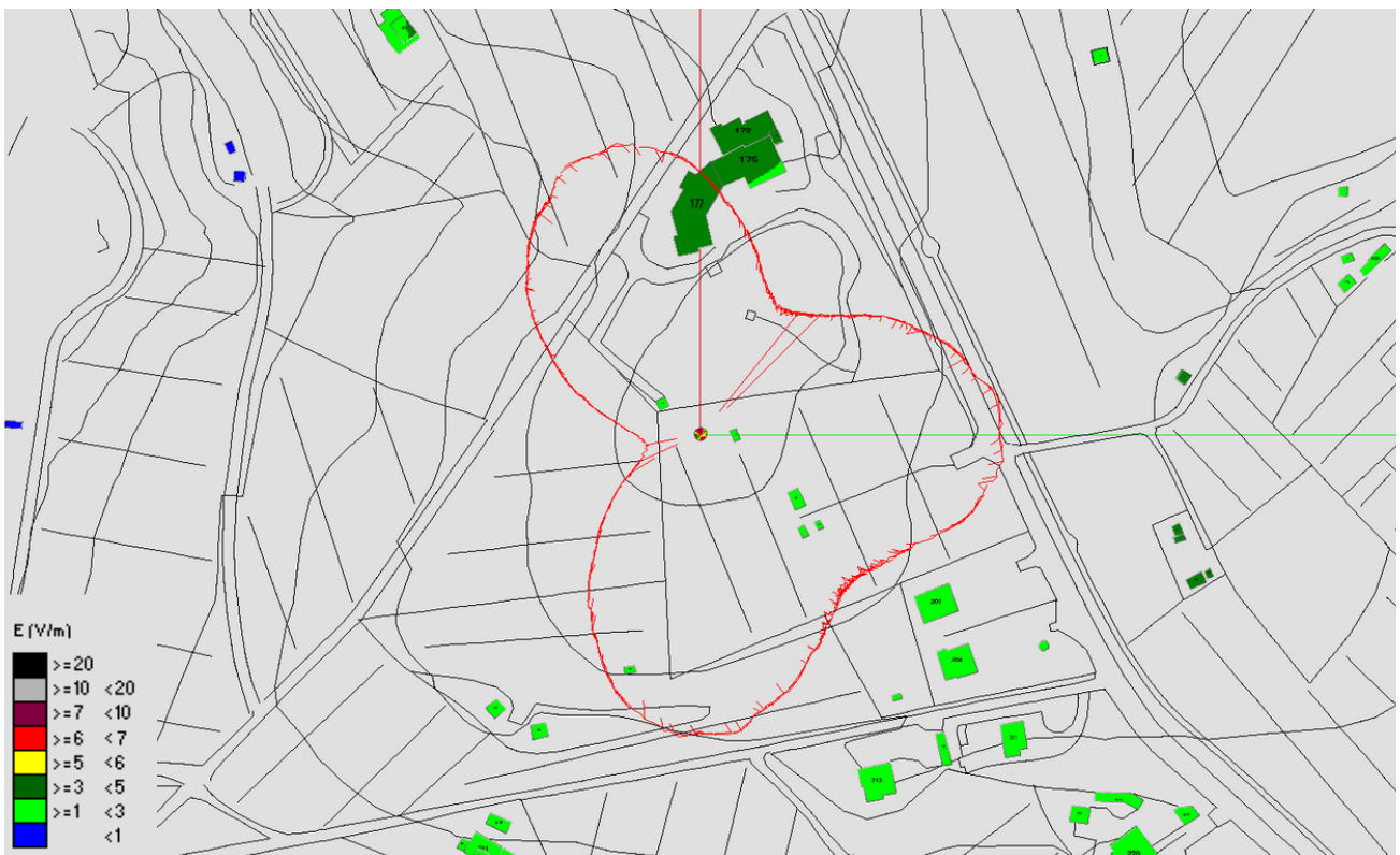
Fig. 13 Impatto elettromagnetico – Zona Torre Piezometrica Str.Spoiano – Vista dall'alto
