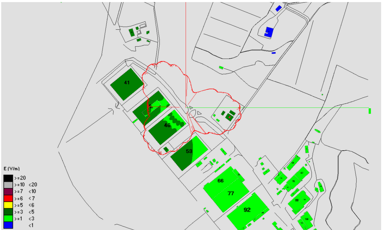
Fig. 23 Impatto elettromagnetico – Zona Area Via Caduti di Nassirya – Vista dall'alto
